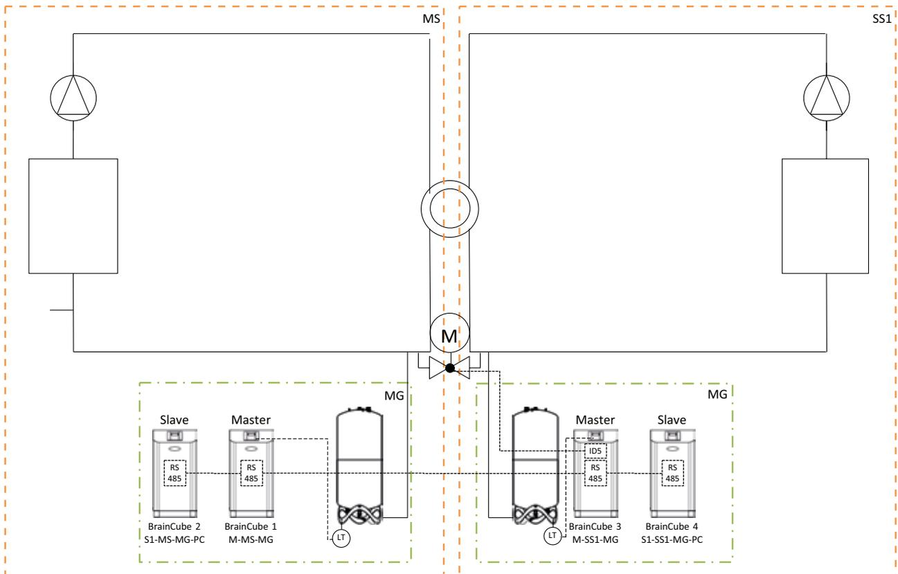
Schema (esempio di impianto di inversione MS-SS1 con valvola motorizzata tra i vasi di espansione Transfero)
